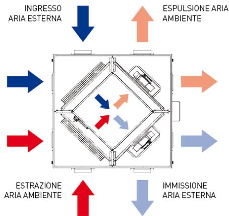
Gli attacchi di immissione/espulsione possono essere configurati come raffigurato in schema e direttamente in fase di installazione in cantiere.
