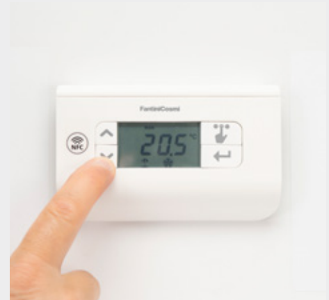
12. Premi più volte il tasto "selezione menu" fino al lampeggio della scritta MAN, poi premi il tasto invio. Regola il set-point di temperatura corrente per verificare l'attivazione/disattivazione del relè di chiamata riscaldamento/raffrescamento
