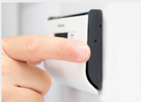
9. Rimonta il pannello frontale inserendo le guide a forcella sotto le rispettive viti. Quindi premi fino all'aggancio della parte inferiore del frontale
