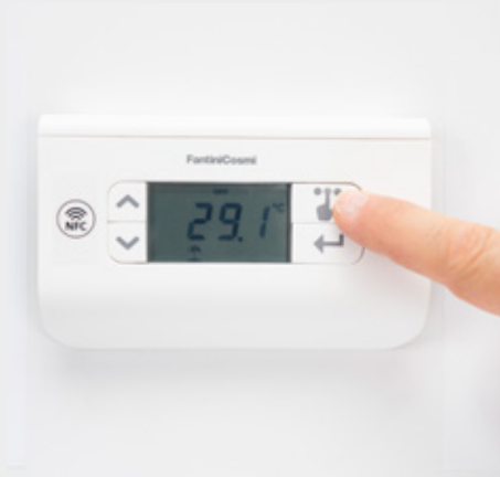
12. Premi più volte il tasto "selezione menu" fino al lampeggio della scritta MAN, poi premi il tasto invio. Regola il set-point di temperatura corrente per verificare l'attivazione/disattivazione del relè di chiamata riscaldamento/raffrescamento
