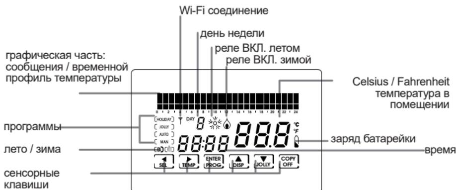
Н.В.: чтобы включить дисплей, нажмите в его центр; если не нажата ни одна клавиша, дисплей выключится после 2-х секунд; но если вы нажмете другие клавиши, выключение произойдет после истечения времени, установленного в параметре LUCE ON (СВЕТ ВКЛ.) (см. Главу 6 CONFIG. PG03).
