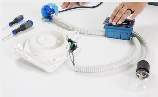
8. Spegnendo la luce, l'aspiratore continua a funzionare per 45", ossia il tempo minimo di funzionamento del timer come fornito da impostazioni di fabbrica.
