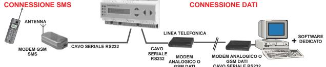
Collegando il regolatore EV85 ad un modem GSM e' possibile ricevere dei messaggi SMS di allarme a seguito della commutazione di uno dei due contatti di allarme disponibili.
