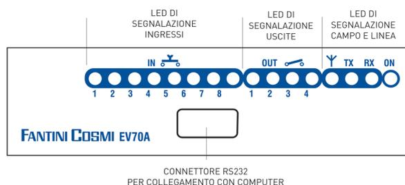
CONNETTORE RS232 PER COLLEGAMENTO CON COMPUTER
