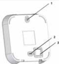
1. Foro per viti di fissaggio superiore
