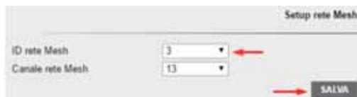
La stessa impostazione di ID rete Mesh va effettuata anche su tutti i Repeaters che fanno parte della rete relativa alla ECVCORB con cui devono comunicare. Per questa operazione è necessario collegare un PC al Repeater da configurare (mediante cavetto USB), utilizzare il Software ECC60MBUS Toolkit e seguire le istruzioni riportate nel relativo manuale
