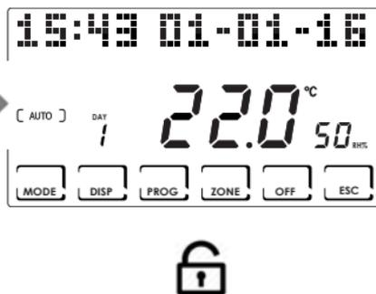
NOTA: con la función **BLOCCO TASTI CON PASSWORD (BLOQUEO DE TECLAS CON CONTRASEÑA)**, se bloquean también las teclas de los CH120RF conectados con el MÁSTER CH180RF.
