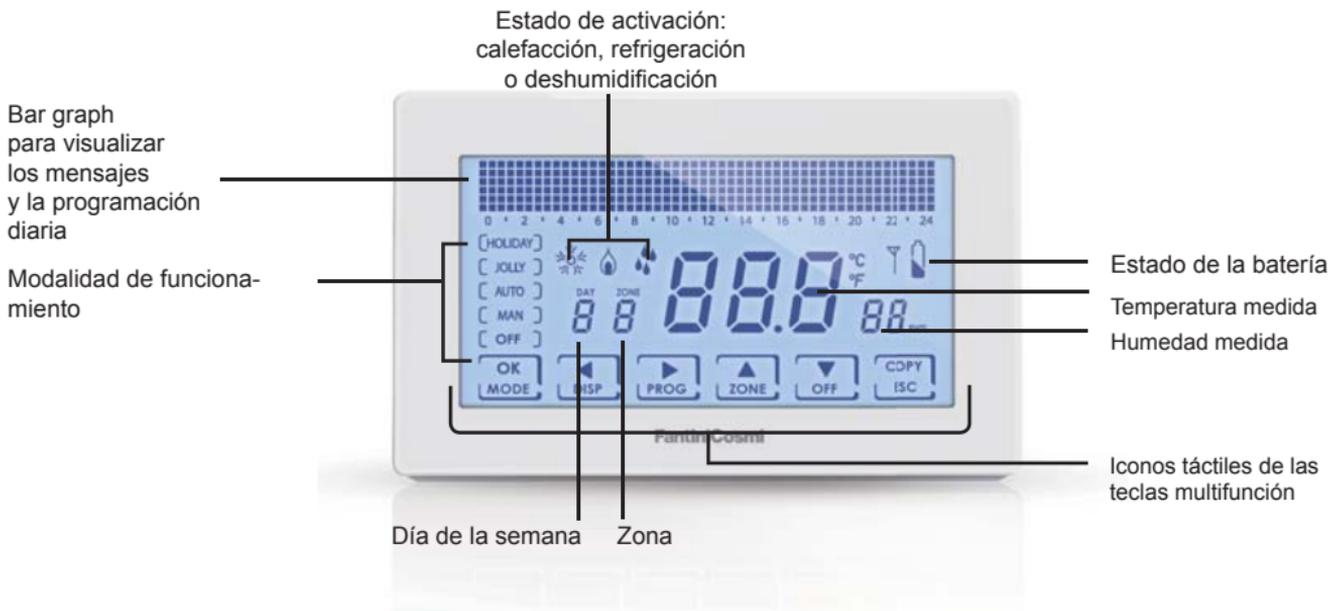
Cuando no se utiliza, el termostato apaga la retroiluminación y las palabras de las teclas y se predispone en **modalidad Stand-by** (ahorro de baterías). Para salir de esta modalidad, mantenga presionada una de las 6 teclas hasta que se encienda la retroiluminación. La duración de la retroiluminación y su intensidad pueden variarse en el menú de programación avanzada PROG.AVANZ. (véase la pág. 40).
