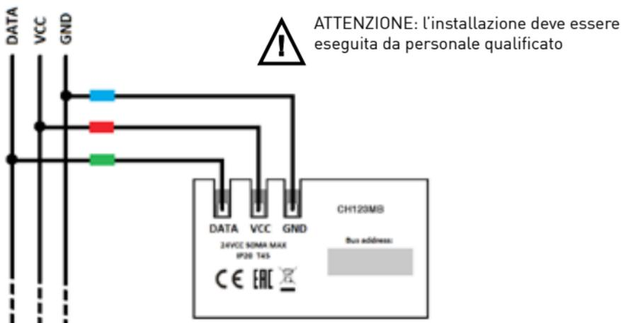
ATTENZIONE: rispettare le polarità dei collegamenti per evitare di danneggiare in modo irreversibile l'apparecchio.
