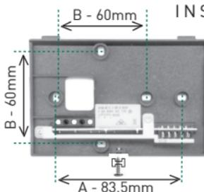
svitare questa vite ruotare il corpo dell'apparecchio verso l'alto per togliere lo zoccolo per il fissaggio
