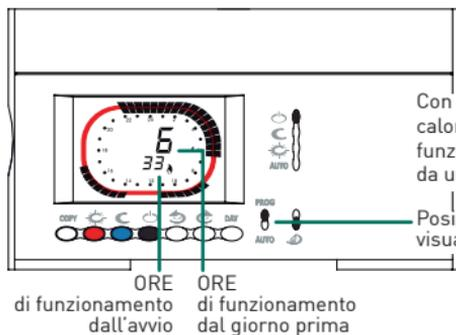
Con C75A è possibile sapere per quante ore è stato richiesto calore il giorno precedente (relè chiuso - ON) e dall'inizio del funzionamento di Intellitherm (dall'inserimento delle pile o da un reset).
