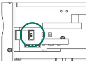
↑ dip switch in ALTO per la protezione ANTIGELO 5°C
