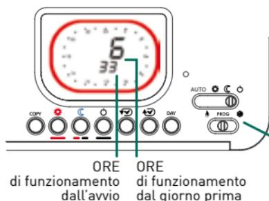
Con C57CT è possibile sapere per quante ore è stato richiesto calore il giorno precedente (relè chiuso - ON) e dall'inizio del funzionamento di Intellitherm (dall'inserimento delle pile o da un reset).
