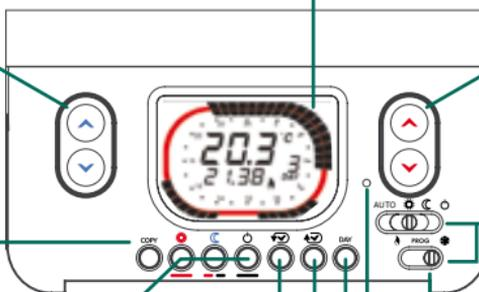
Teclas para la regulación de la temperatura máxima TMAX/ CONFORT desde 2° hasta 62°C.
