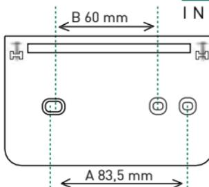
Pour séparer du corps frontal le socle pour le fixation, enlever le couvercle du logement des piles et dévisser les vis de haut, en tournant le corps de l'appareil vers le bas pour l'extraire.
