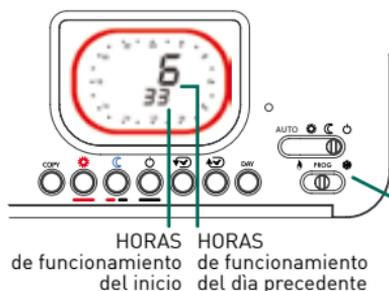
Con C57CT es posible saber por cuantas horas el calor ha sido solicitado el día precedente (relé cerrado - ON) y desde el principio de funcionamiento de IntelliTherm (colocación de las pilas o reseteado).
