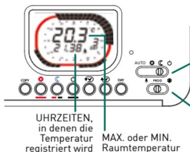
Mit IntelliTherm C57CT ist es möglich, die MIN. und MAX. Temperatur, die der Raum am vorhergehenden Tag erreicht hat, sowie die Uhrzeit der Messung zu überprüfen.
