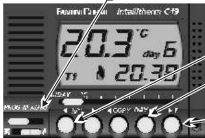
2 - Impostare con i tasti **H** le ore in cui il funzionamento automatico deve essere escluso oppure impostare con il tasto **D** i giorni in cui il funzionamento automatico deve essere escluso
