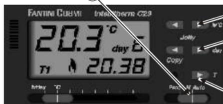
**2** - Impostare con il tasto **H** le ore in cui il funzionamento automatico deve essere escluso oppure impostare con il tasto **D** i giorni in cui il funzionamento automatico deve essere escluso
