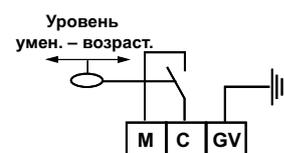
СХЕМА СОЕДИНЕНИЙ ДЛЯ НАСОСА ОПОРОЖНЕНИЯ
