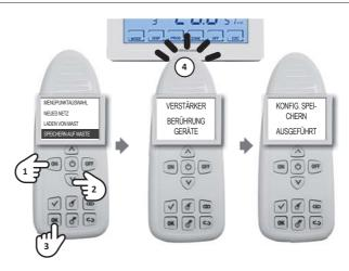
HINWEIS: nach der Inbetriebnahme des Systems muss die Konfiguration immer auf CH180RF gespeichert werden.
